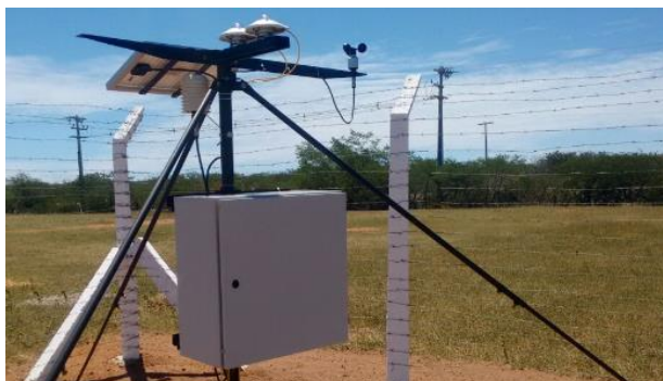
Fotografia 2 – Detalhe dos sensores da estação solarimétrica
